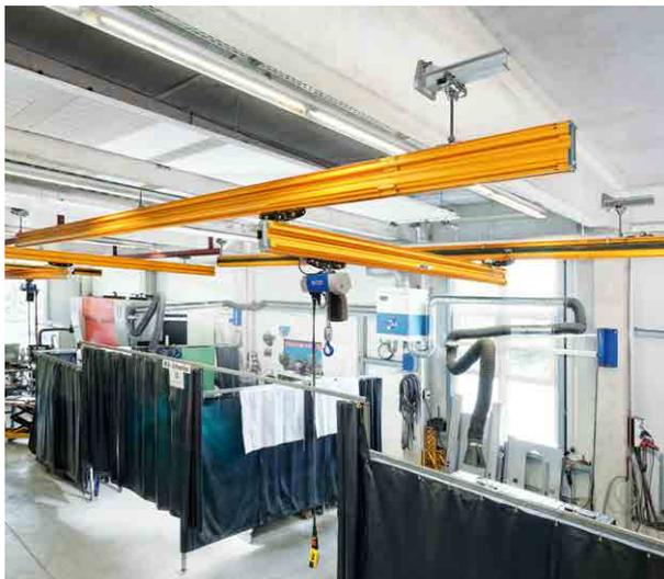
Normalkonsolen werden seitlich an den Hallenbindern befestigt. Die Befestigung erfolgt mittels Durchgangsankern. Es gibt sie sowohl für Beton- als auch für Holz-binder und mit unterschiedlich langen Ausladungen.
